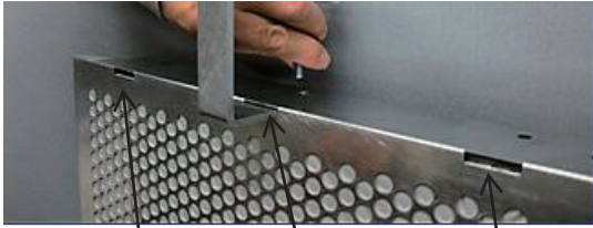
左側 吊金具差込穴
