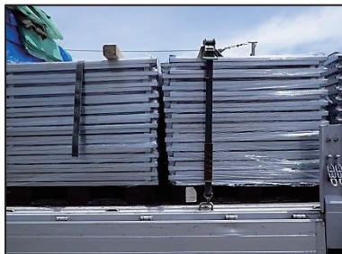
ラッシングで固定してください ※締めすぎにご注意ください
